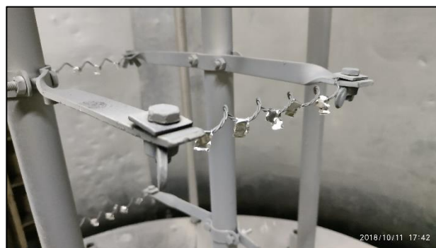
左图：真空镀膜机；右图：蒸发源及铝片。
